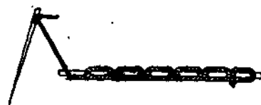
Fig. 3.2. Punctul în urma acului văzut în secțiune.
