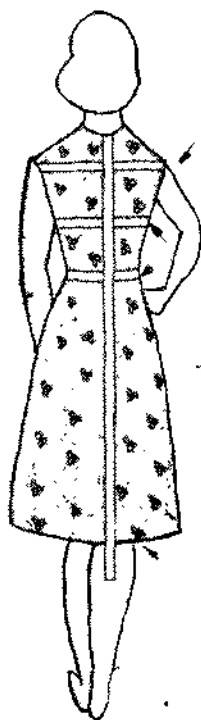
Fig. 6.7. Dimensionarea înălțimii umerilor, lungimii răscoielii mânecii la spate ( ars ), lungimea taliei ( L_t ), lungimea produsului ( L_{pr} ).
